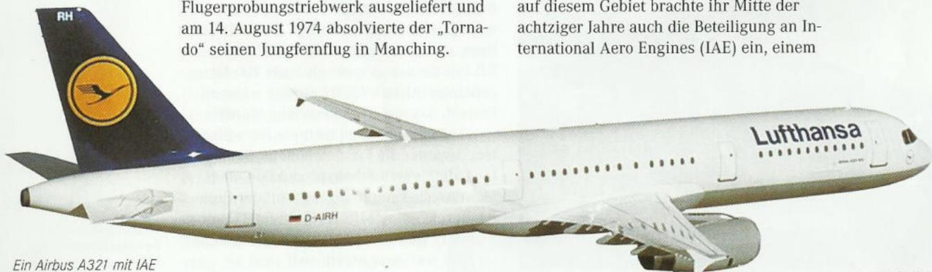
Ein Airbus A321 mit IAE V2500-Triebwerken.
