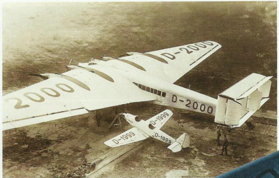
Großflugzeug G 38 im Vergleich mit einer zweiseitigen Junkers A 50 (oben): Spannweite 44 Meter, Länge 23,2 Meter und Gesamtgewicht 24 Tonnen – das waren vor 70 Jahren neue Dimensionen im Flugzeugbau. Reisegeschwindigkeit: 208 Stundenkilometer.
