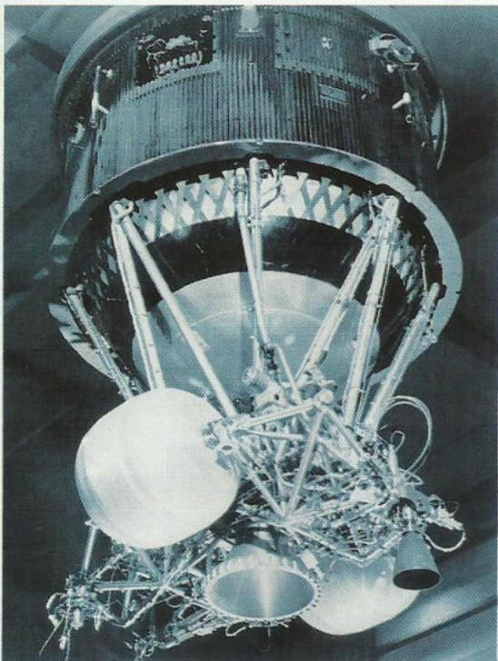
Triebwerk der dritten Stufe der Europarakete vor einem Vakuumtest.
