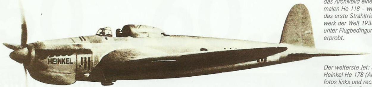
Unter dem Rumpf einer Heinkel He 118 - links das Archivbild einer normalen He 118 - wurde das erste Strahltriebwerk der Welt 1938/39 unter Flugbedingungen erprobt.
