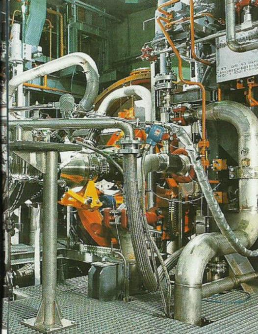
Die Schubkammer des Vulcain-Triebwerkes der Ariane 5 auf dem Dasa-Prüfstand in Lampoldshausen.
