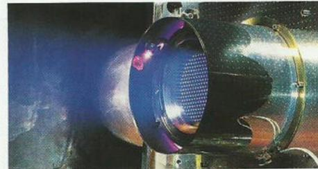
Kam erstmals auf der Forschungsplattform Eureca (oben) zum Einsatz: Das Radiofrequenz-Ionentriebwerk RIT-10 aus Ottobrunn.
