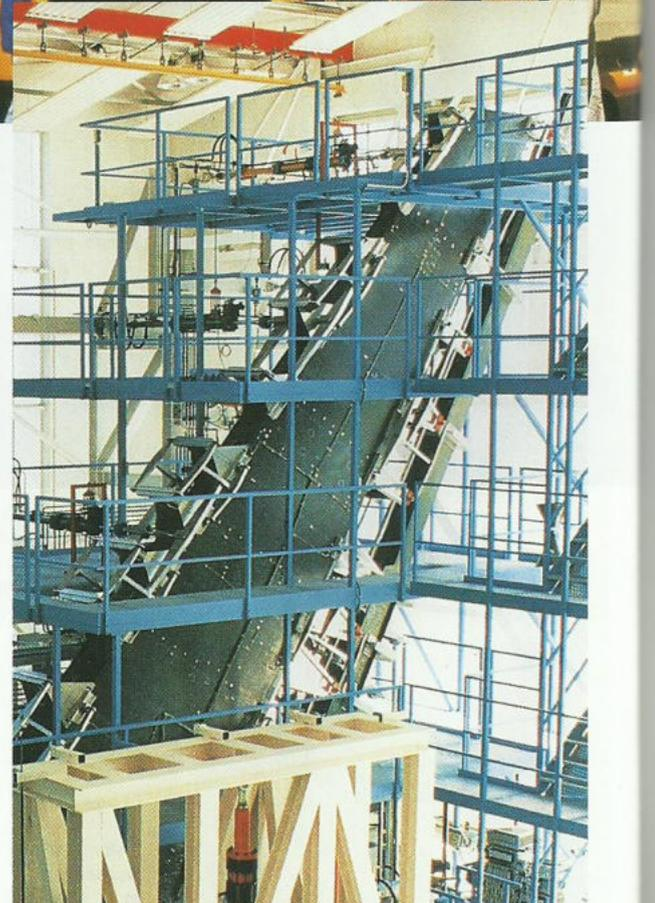
Im Luftfahrtversuchszentrum in Hamburg wurden bis 1998 die CFK-Seitenleitwerke getestet. Jetzt kann mit den Verbundstoffen gearbeitet werden.
