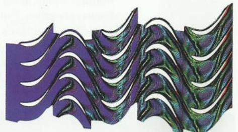
Berechnung der Strömung in einer mehrstufigen Niederdruckturbine mit instationären Rechenverfahren.
