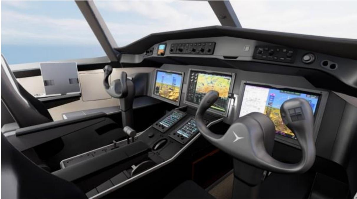
**Bild 3: Companion™-Flugdeck der D328eco; Quelle Deutsche Aircraft Media Kit**
