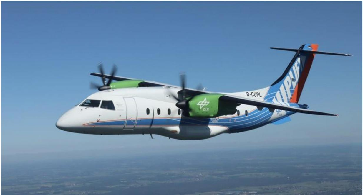
**Bild 4: Do 328-100 Flying Testet für zukünftige Antriebs-, Treibstoff- und Systemtechnologien; Quelle DLR**
